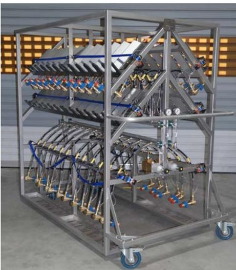
Dieses kompakte, mobile Ablagesystem definiert das Konzept der Flexibilität neu und ermöglicht einen sichereren und vielseitigeren Abfüllvorgang mit medizinischem Sauerstoff für verschiedene Zylindergrößen. Die Vorbereitung der Flaschen und die Abfüllung lassen sich mit diesem rollbaren Wagen räumlich trennen. Schutzeinhausungen in Edelstahl und/oder Polycarbonat (PC) können auf Ihre Anforderungen hin leicht hinzugefügt werden.
